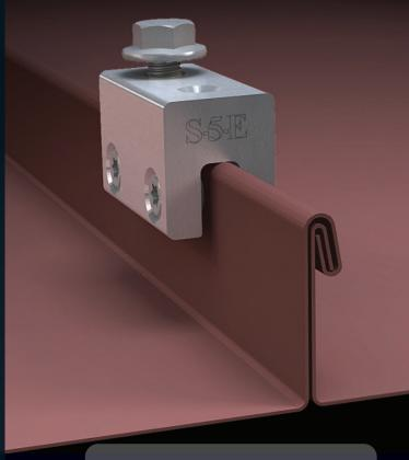
La abrazadera S-5-E se fija con nuestros tornillos de punta redonda patentados sin perforar el panel del techo de metal, preservando así la garantía del fabricante del mismo.
